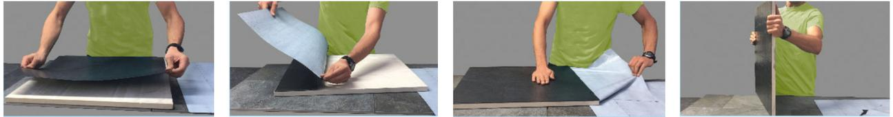
**N.B.:** die Verwendung einer Rolle erleichtert die Anbringung und verbessert die Haftung der Matte.
